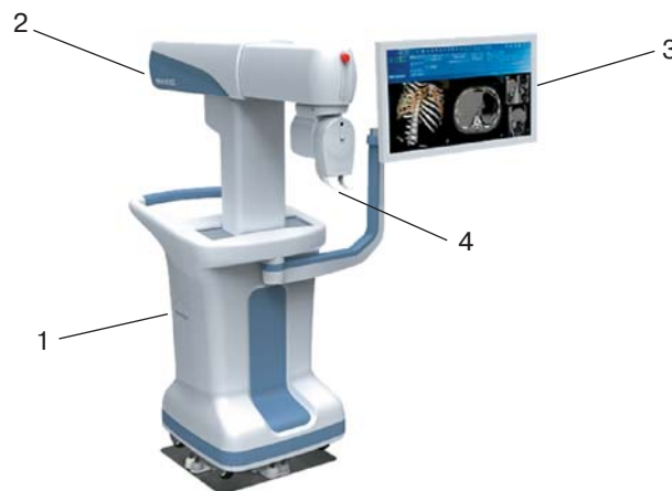
Рис. 1. Роботизированная приставка Maxio® Perfint (внешний вид). 1 – стойка; 2 – рука-манипулятор; 3 – монитор; 4 – пластина-фиксатор (стрелки).
